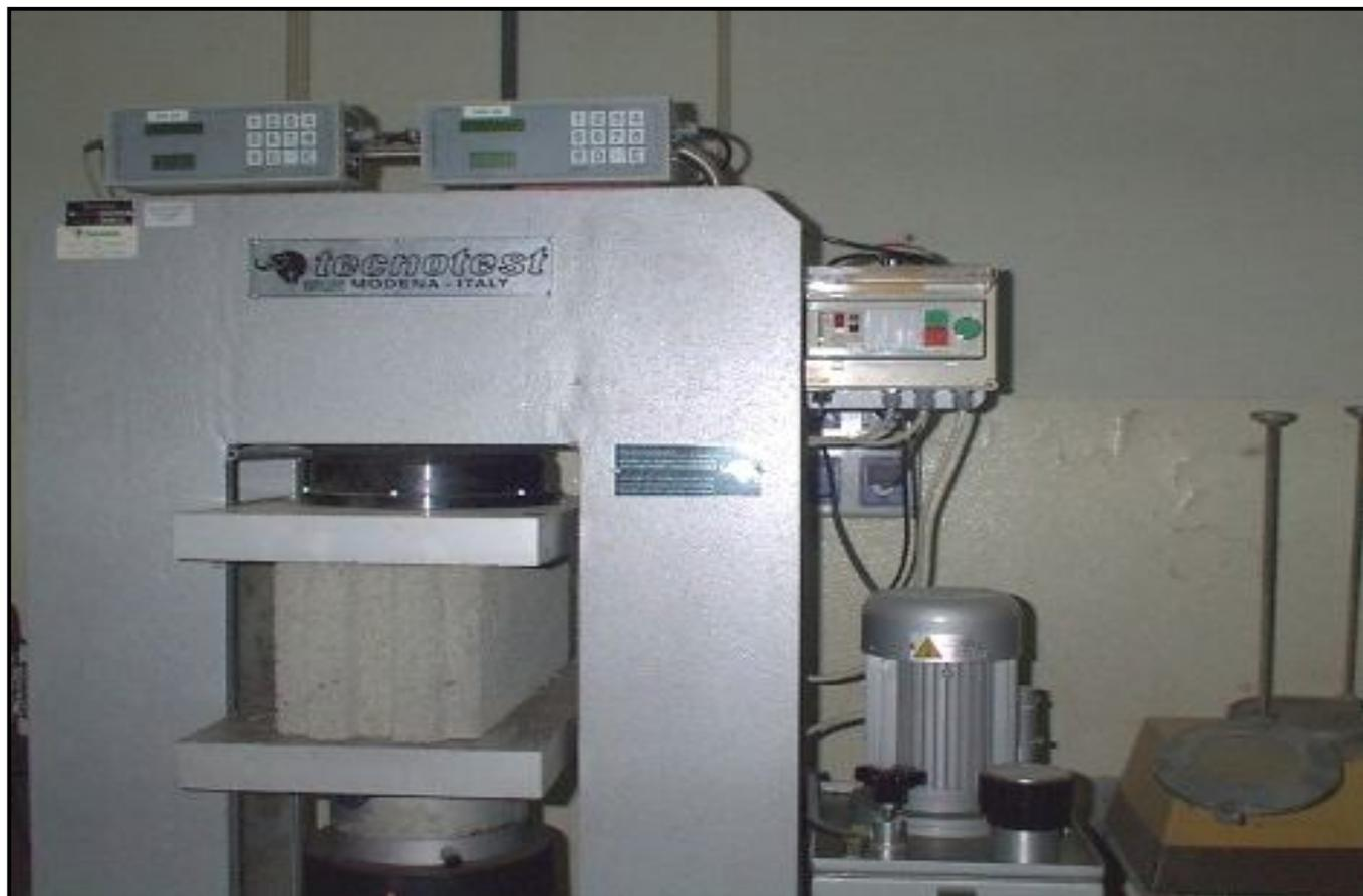
Os blocos para ensaio foram regularizados por desgaste. Os ensaios foram realizados em prensa calibrada por uma entidade acreditada.
